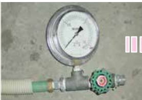
メータユニットから検査する事により、 テスト用継手不要!
