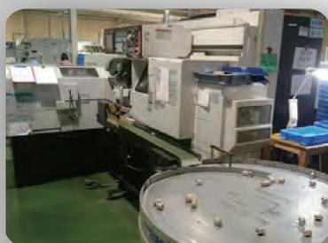
加工品をターンテーブルに集め、傷の有無を検査して箱詰め
